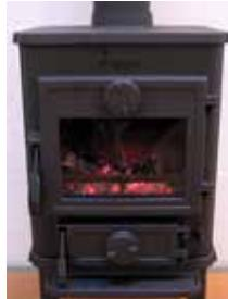
6. Der lægges 2-3 stykker brænde à ca. 0,5 kg og ca. 25 cm lange ind over gløderne i ét lag med en afstand på ca. 1 cm mellem træstykkerne.
