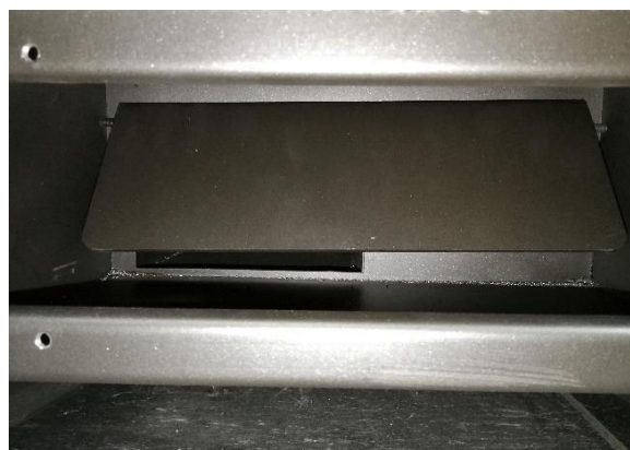
Bild 2: Kontrollera att rökstyrningsplåten är korrekt placerad på krokarna.
